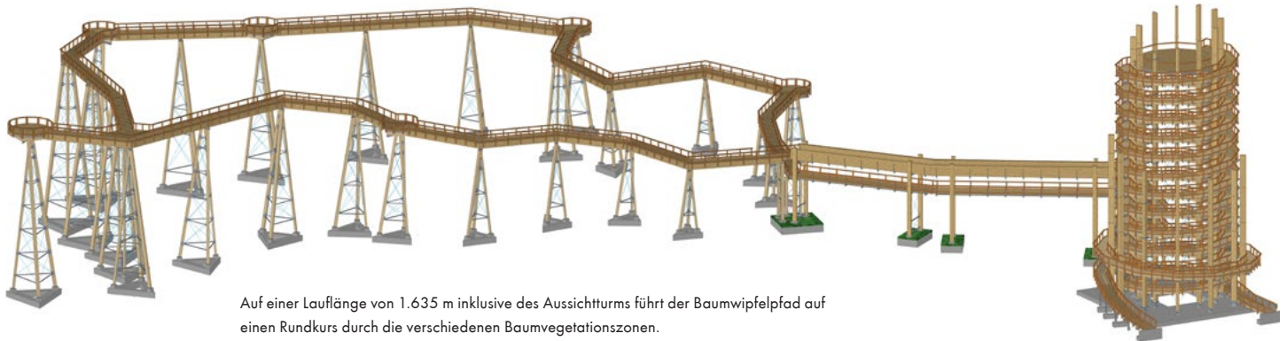
Vom Turm ausgehend führt eine 520 m lange Brücke mitten durch die Baumkronen von Nutscheid und hilft, Flora und Fauna spielerisch zu entdecken.
