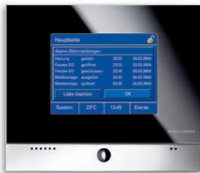
Controlpanels bieten zahlreiche Funktionen zum Schalten und Steuern der KNX-Anlage
